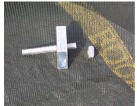
3 Grundplatte mit Gewindestange und Stopmutter
